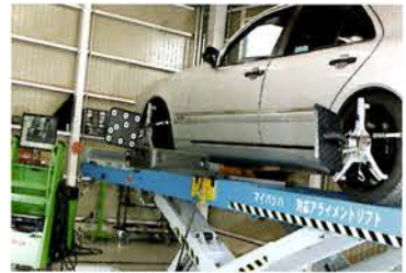
ローダウンさせたらテスターでアライメントを計測して適正値に矯正すること。スポーツ系の車種ではタイヤのグリップ力を引き出すため、独自のアライメントに設定することもある
